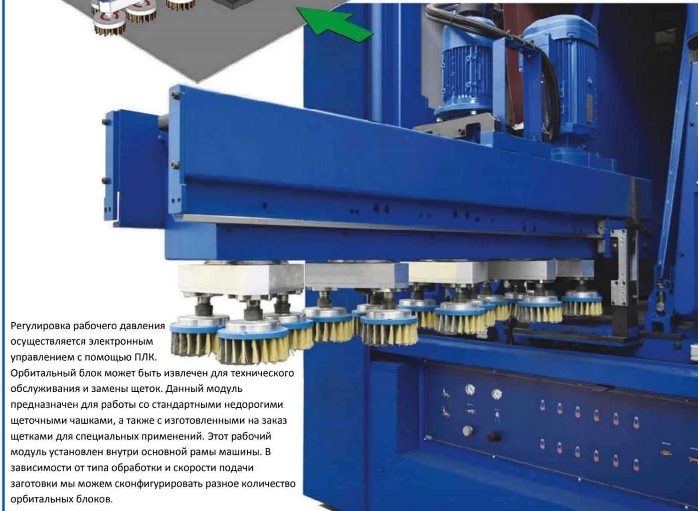
Регулировка рабочего давления осуществляется электронным управлением с помощью ПЛК.
