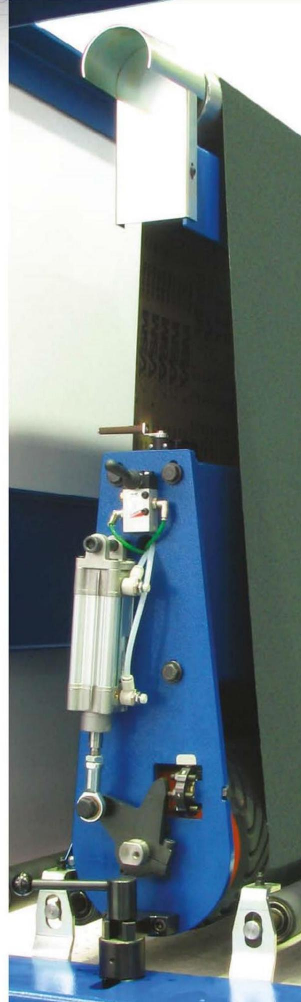
Цилиндр с покрытием из резины специального назначения, маслоупорный и термостойчивый. Специальные подшипники для работы на сверхвысоких скоростях.
