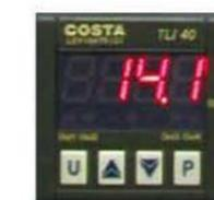
Электронный дисплей для отображения толщины обработки. С тонкой настройкой до 0.1 мм
