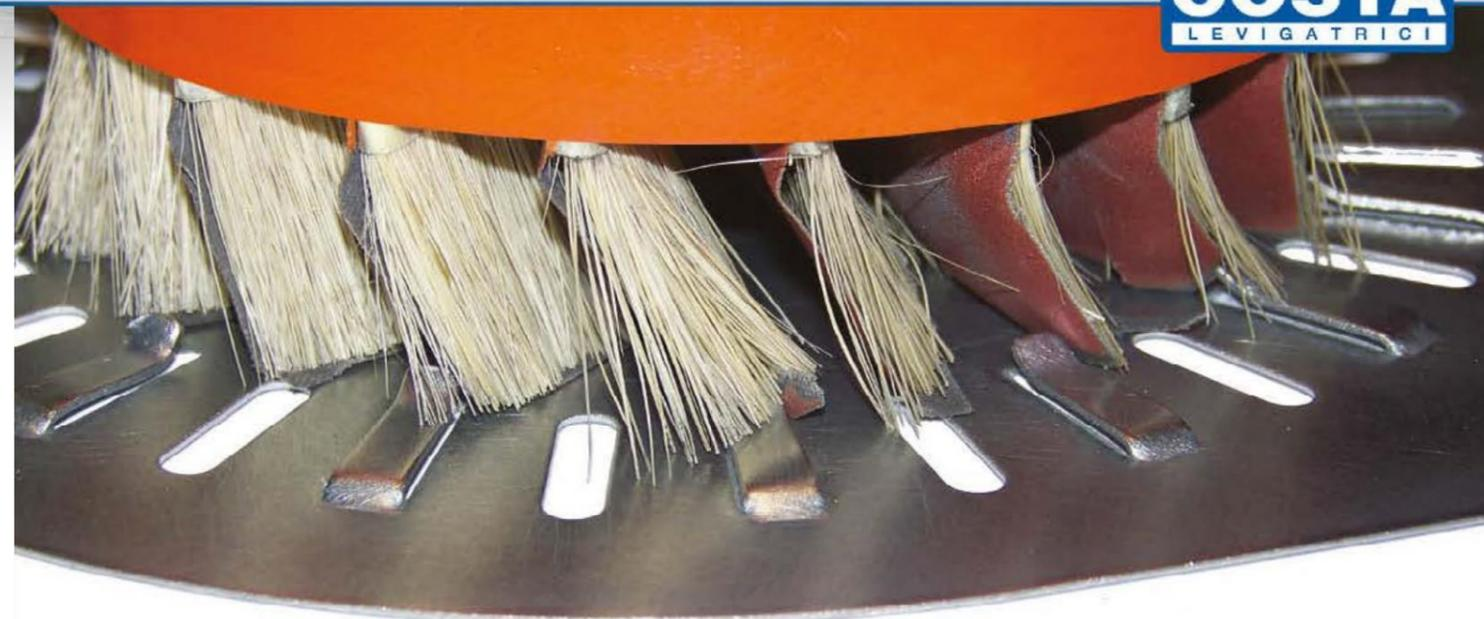
Данное устройство состоит из серии стандартных вертикальных шлифовальных щёток, вращающихся с высокой скоростью (инверторная система управления) и совершающих колебательные движения с регулируемой частотой. Сочетание вращения вертикальной оси с высокочастотными колебаниями позволяет добиться идеального удаления заусенцев во всех направлениях с помощью одного рабочего модуля.
