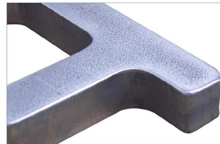
Снятие заусенцев и полировка (косметическое шлифование) горячекатаной/холоднокатаной нержавеющей стали, алюминия для отделки Duplo и/или Scotch-Brite™ с использованием станка в конфигурации «CCS»
