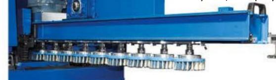
XVS Ø 85 мм щетки со стальной проволокой для удаления оксидной пленки
