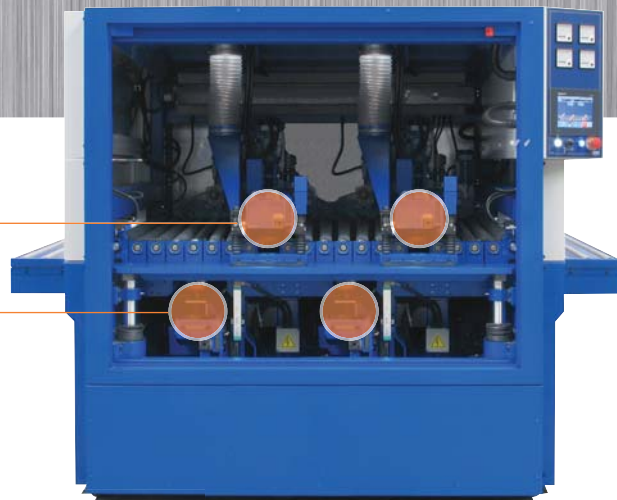
MB4 станок с 4-мя рабочими модулями (два верхних и два нижних)
