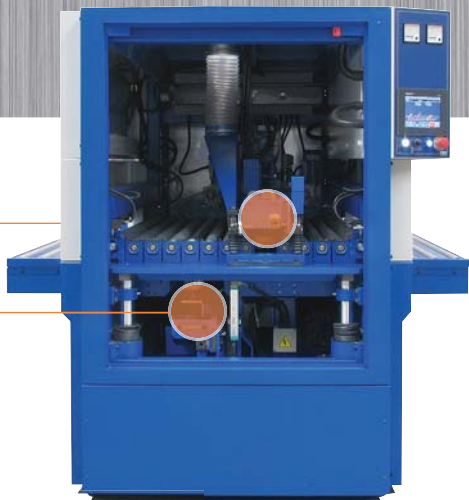
MB2 станок с 2-мя рабочими модулями (один верхний и один нижний)
